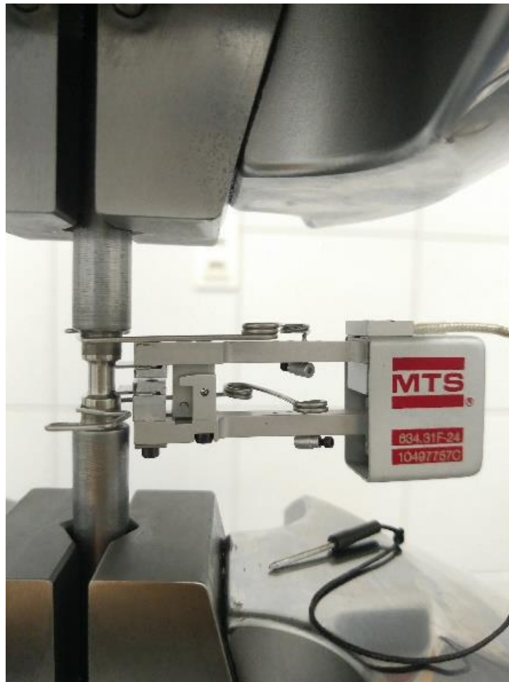
Figura 33 – Montagem do corpo de prova de tração transversal all weld, antes do ensaio
