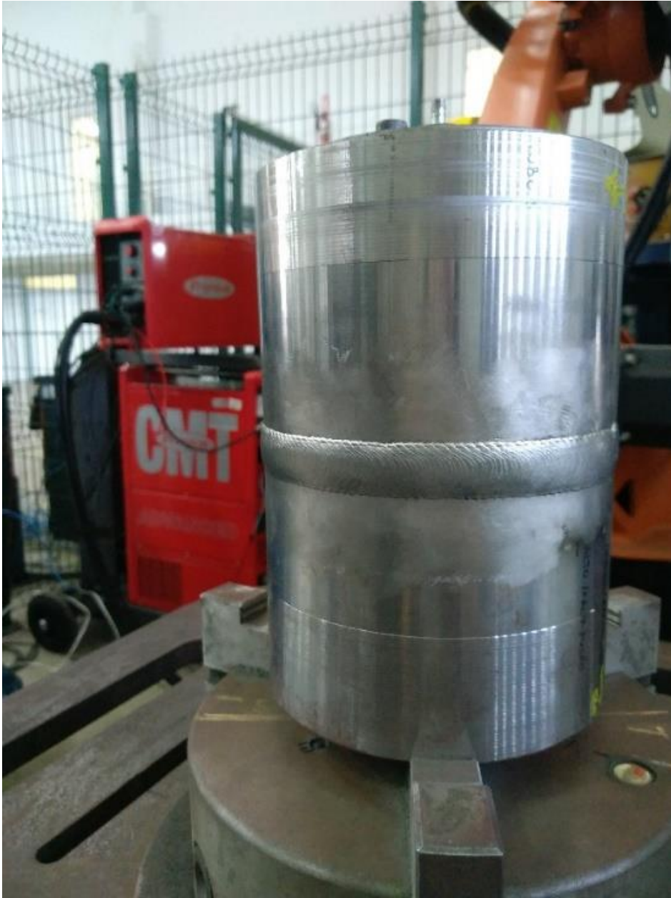
Figura 47 – União completa da junta 3 com reforço e bom acabamento superficial.
