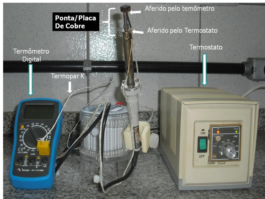
**Figura 15.** Equipamento completo utilizado para realização da queimadura. Observar termômetro digital, termopar tipo K na ponta, estabilizador de corrente elétrica com termostato interno. (Fonte: arquivo pessoal).
