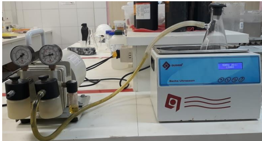
Figura 03 - Desaeração dos revestimentos.
