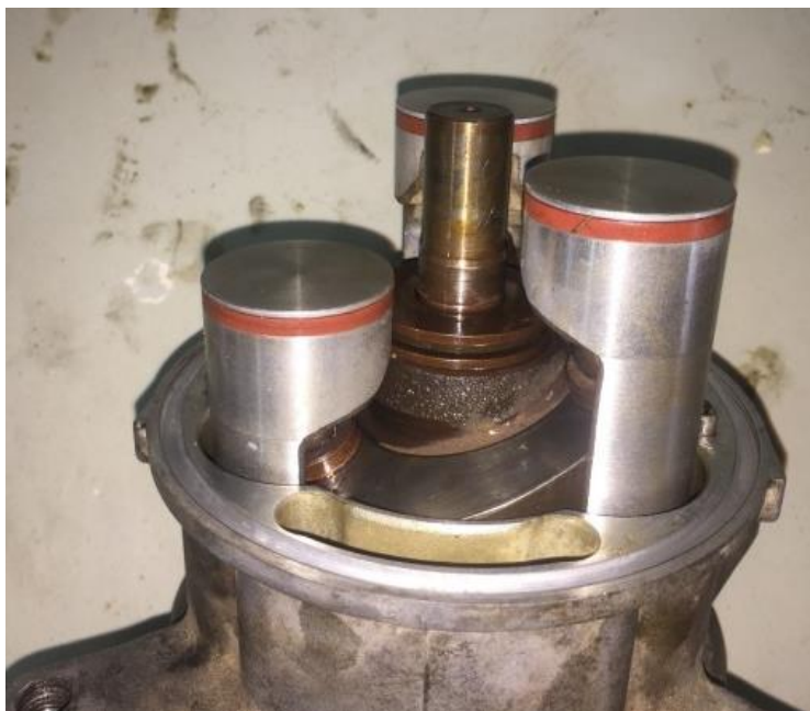
Figura 48 – Componentes montados e limpos (placa de arrasto, carcaça e pistões).
