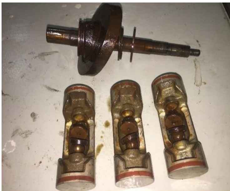
Figura 47 – Componentes desmontados e sujos (placa de arrasto e pistões).
