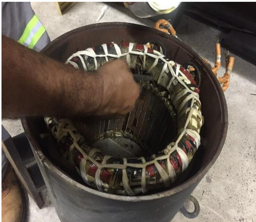
Figura 41 – Amarração e envernizamento das bobinas do alternador.
