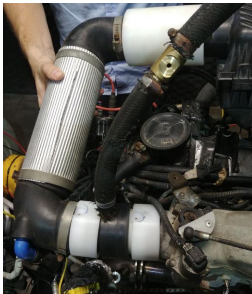
Figura 12– Adaptadores para aferição de pressão de ar, combustível e mistura ar/combustível. (Os pontos de medição sinalizados com seta vermelha)
