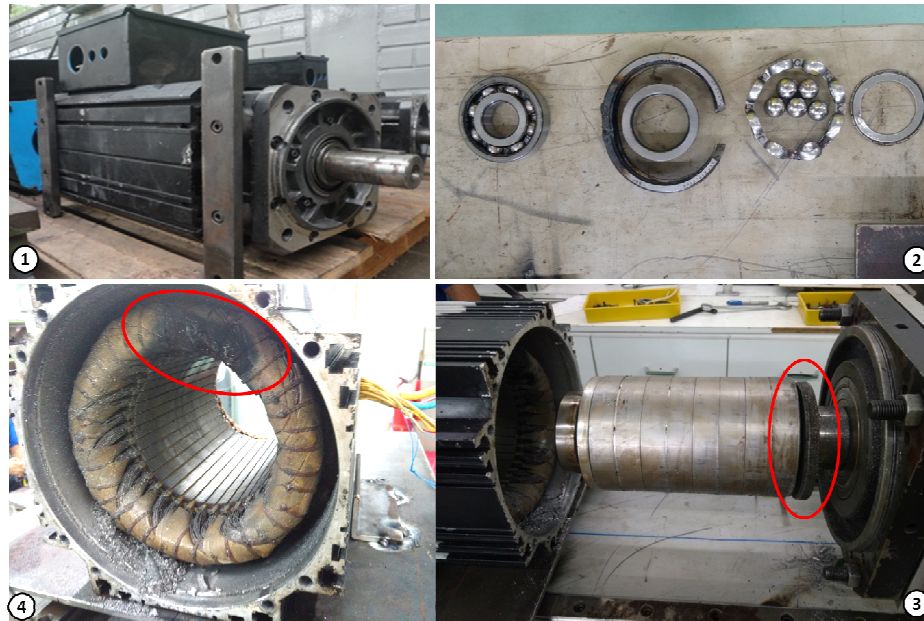
Figura 3.2 – PMSM da marca Phase, modelo U31010F20.3 de 28,3 kW que apresentou defeito.
