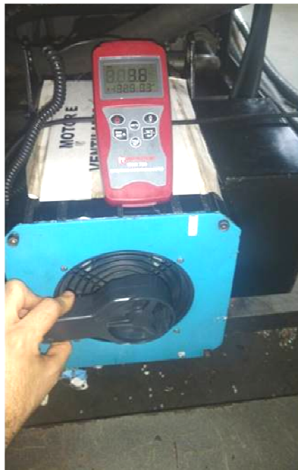
Figura 3.7 – Procedimento experimental: análise da rotação e da vazão de ar do sistema de ventilação forçada em um PMSM de 23 kW.
