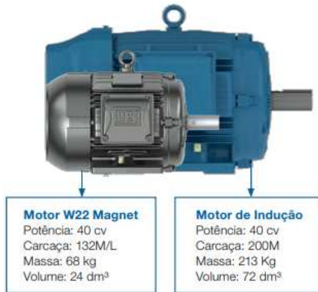
Figura 2.4 – Comparação de volume entre motor de indução e o motor síncrono de ímã permanente.
