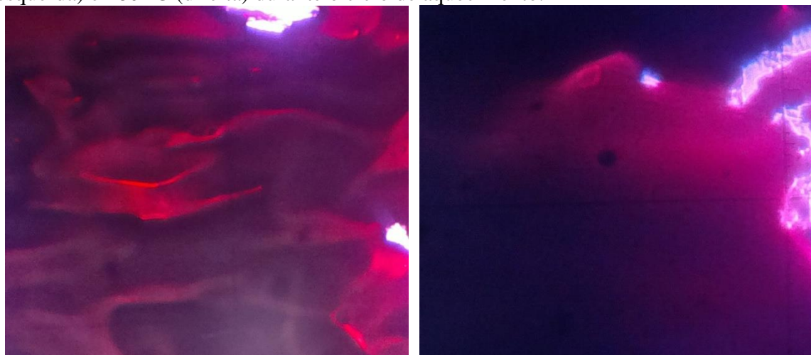
Figura 61 – Imagens das texturas da nova porfirina assimétrica 4a a temperatura ambiente (esquerda) e 180 °C (direita) durante o ciclo de aquecimento.
