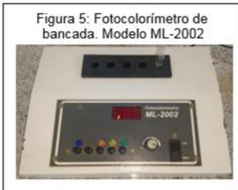
Figura 5: Fotocolorímetro de bancada. Modelo ML-2002
