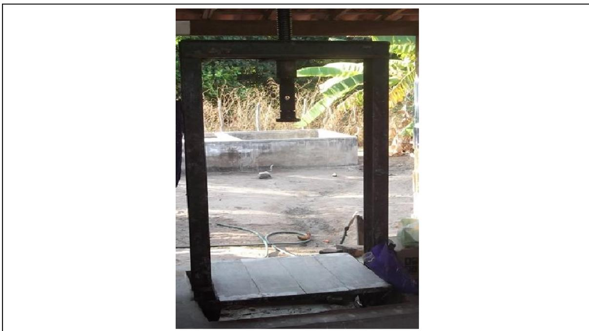
Foto 14: Prensa de fusão usada para prensar a massa de mandioca na casa de farinha (elaborado pelo autor)
