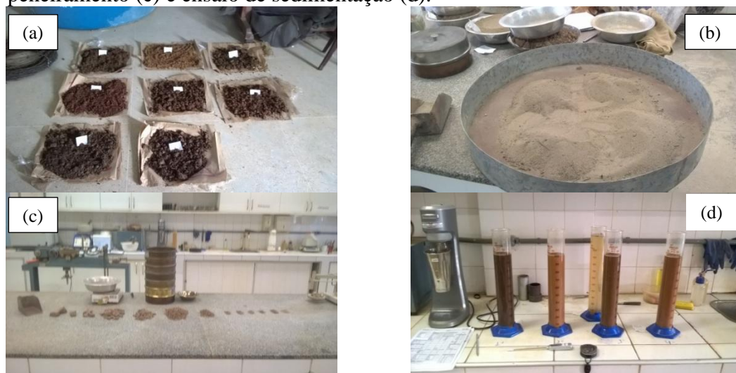
Figura 9 – Amostras secando ao ar (a), quarteamento das amostras (b), ensaio de peneiramento (c) e ensaio de sedimentação (d).
