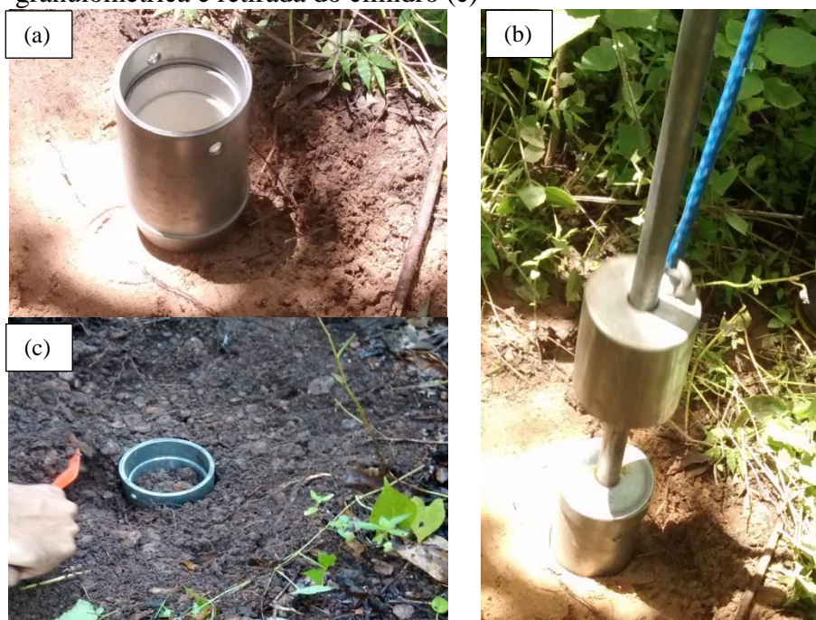
Figura 8 – Coletor de amostras indeformadas (a), cravação do amostrador com cilindro (b) e coleta do material para análise granulométrica e retirada do cilindro (c)
