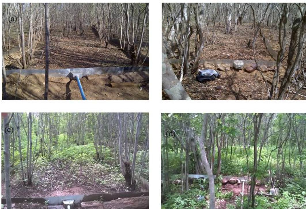
Figura 5 – Parcelas de erosão (Wischmeier) no período seco: parcelas P08 (a) e P40 (b); e no período chuvoso: parcelas P08 (c) e P40(d).
