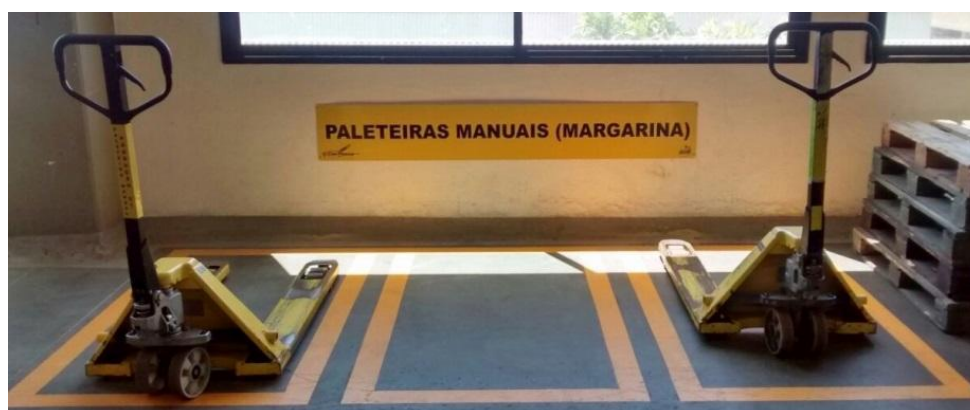
Figura 26 – Identificação da área de paleteiras manuais
