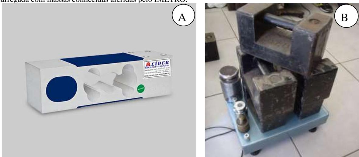
A calibração do lisímetro é uma das etapas mais importantes durante a implantação do equipamento, pois calibrações malfeitas levam a interpretações inconsistentes dos valores de transpiração, principalmente quando se trabalha em curtos períodos de tempo. Por esse motivo foi realizada a calibração das células de carga que fazem parte do sistema experimental constituído do lisímetro de pesagem.
