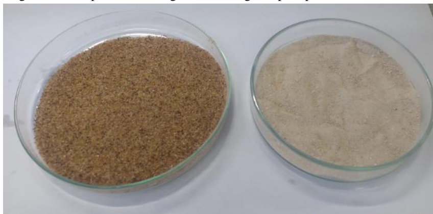
Figura 5 - Comparativo entre goma bruta e goma precipitada.
