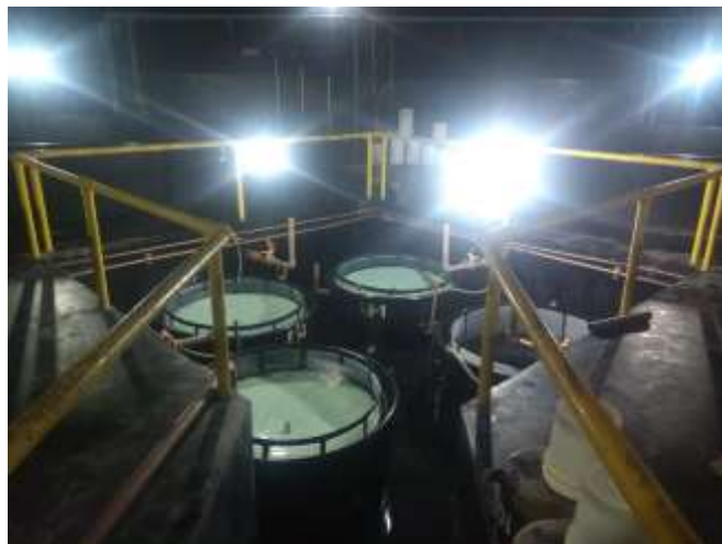
Figura 07 – Coletores de ovos de 300 L, com tela de filtração de 100 micrômetros, situados no setor de desova da CELM Aquicultura.
