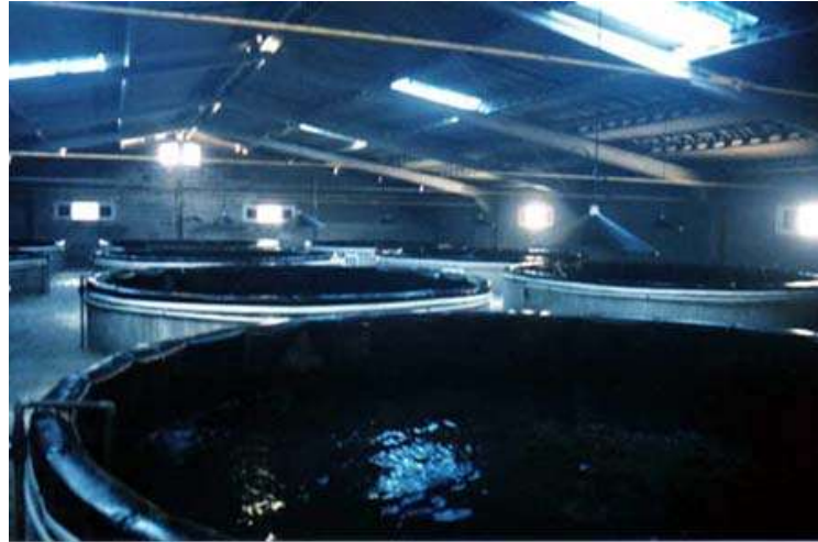
Figura 06 – Setor de reprodução do laboratório da CELM Aquicultura Ltda, composto por 27 tanques de 10 m 3 cada.
