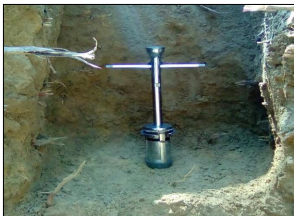
Figura 1 – Trado tipo Uhland para coleta do material indeformado.
