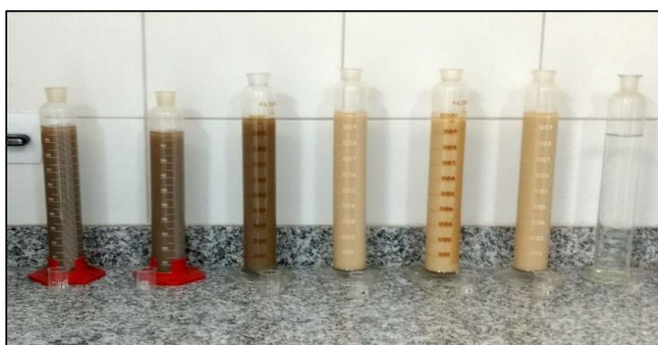
Figura 2 – Amostras dos horizontes A e Bt com caráter coeso e prova em branco, respectivamente, em solução para análise granulométrica.
