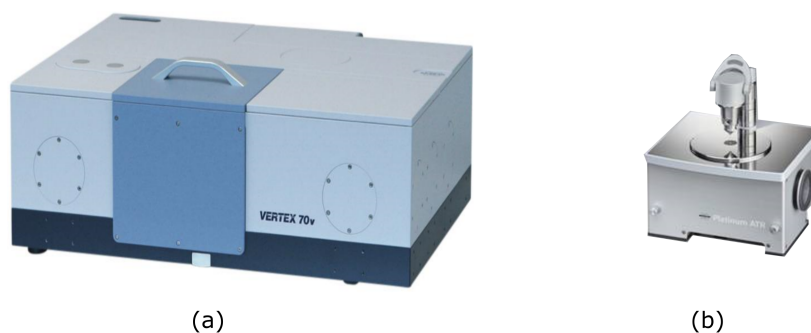
Figura 2.3 – (a) Espectrômetro Vertex70v da Bruker; e (b) Acessório de reflectância total atenuada (Platinum- ATR).
