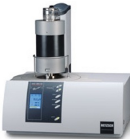
Figura 2.4 – DSC 200 F3 da Netzsch utilizado no experimento de calorimetria exploratória diferencial (DSC).
