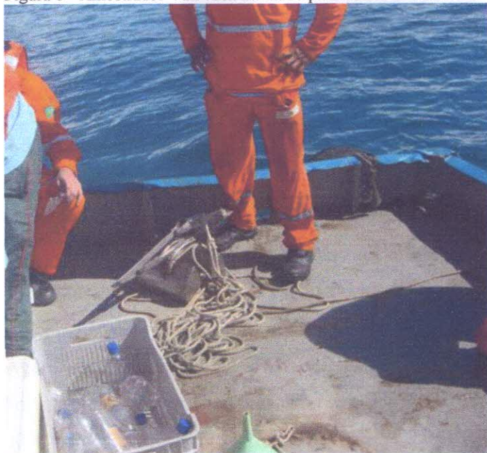
Figura 6 - Amostrador Van veen utilizado para coleta de sedimento do fundo marinho.
