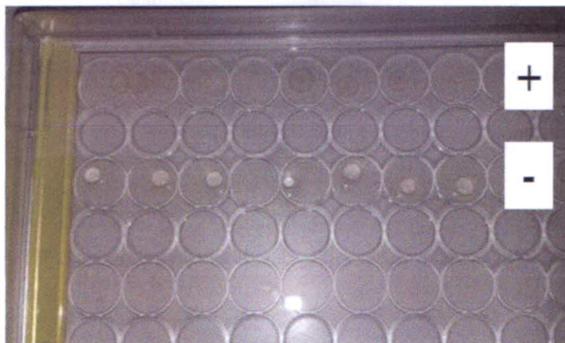
Figura 11 –Teste do colapso da gota.
