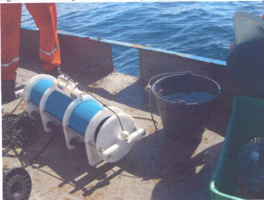
Figura 5 - Garrafa do tipo Van dorn utilizada para coleta de água.
