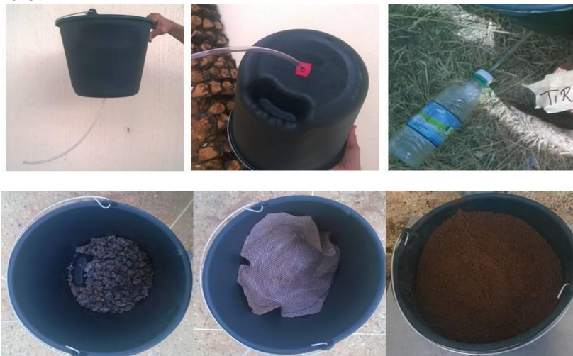
Figura 11 - Confecção de lisímetro de drenagem para o cultivo de manjeriço que foi implantado na UFCA. Crato, 2015.
