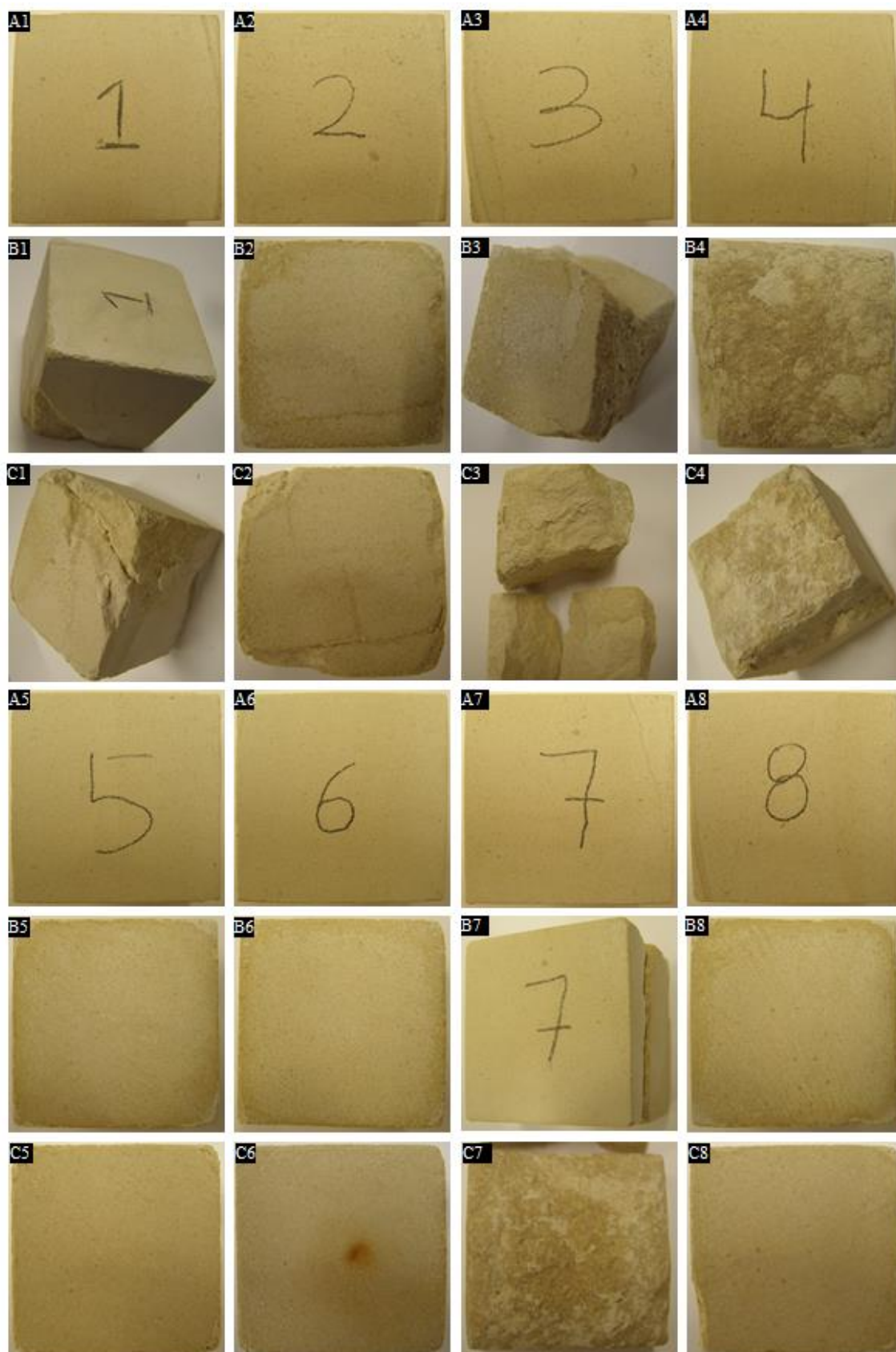
Figura 57 – Imagens do calcário Filstone Beije MF antes (A), após o primeiro ciclo (B) e após o segundo ciclo (C).
