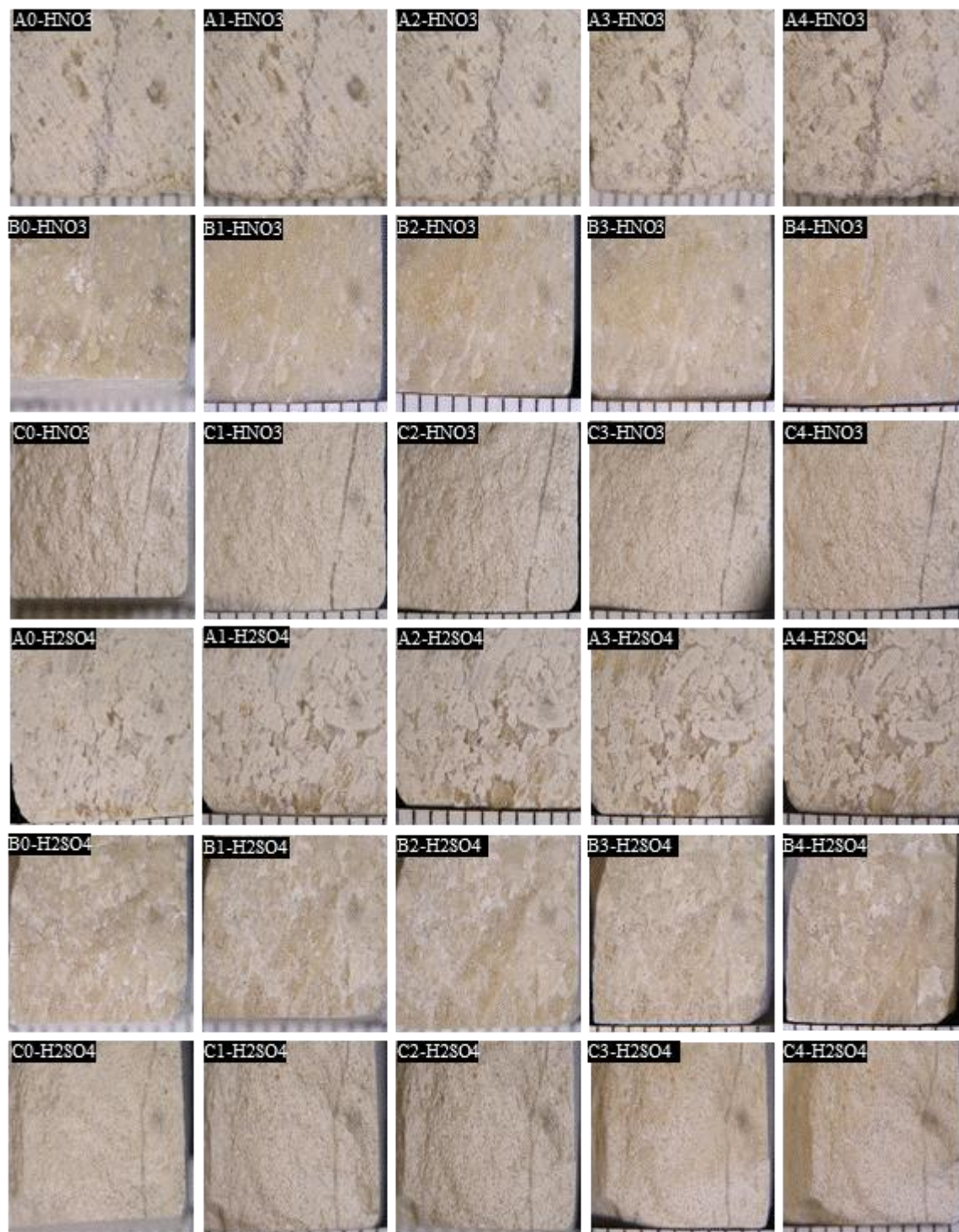
Figura 54 – Imagens do calcário Filstone Blue (A), Crema Paraná (B) e Filstone Beije MF (C) antes do ensaio com extrator de Soxhlet (0) e após os ciclos 1, 2, 3 e 4 aos reagentes \text{HNO}_3 e \text{H}_2\text{SO}_4 .
