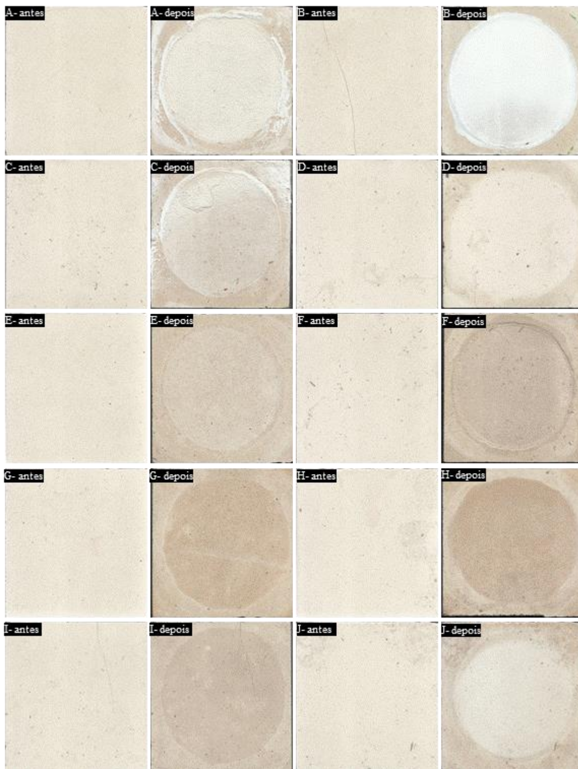
Figura 48 – Imagens do calcário Filstone Beije MF antes e após o ataque químico, com os seguintes reagentes: (A) Hidróxido de Potássio (KOH) 30 g/L, (B) Hidróxido de Potássio (KOH) 100 g/L, (C) Ácido Clorídrico (HCl) 3%, (D) Ácido Clorídrico (HCl) 18%, (E) Água (H 2 O), (F) Hipoclorito de sódio (NaClO) 20 mg/L, (G) Cloreto de amônio (NH 4 Cl) 100 g/L, (H) Ácido Acético (CH 3 COOH) 3%, (I) Ácido Cítrico (C 6 H 8 O 7 ) 100 g/L e (J) Ácido Láctico (C 3 H 8 O 3 ) 5%.
