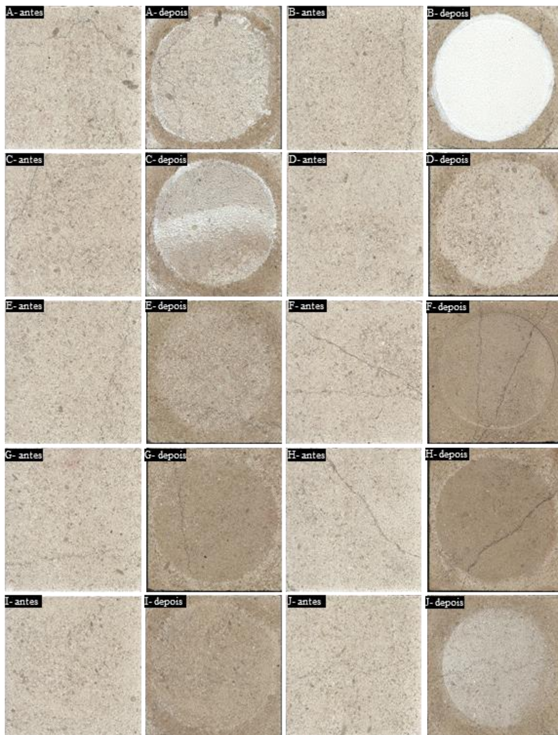
Figura 49 – Imagens do calcário Filstone Blue antes e após o ataque químico, com os seguintes reagentes: (A) Hidróxido de Potássio (KOH) 30 g/L, (B) Hidróxido de Potássio (KOH) 100 g/L, (C) Ácido Clorídrico (HCl) 3%, (D) Ácido Clorídrico (HCl) 18%, (E) Água (H 2 O), (F) Hipoclorito de sódio (NaClO) 20 mg/L, (G) Cloreto de amônio (NH 4 Cl) 100 g/L, (H) Ácido Acético (CH 3 COOH) 3%, (I) Ácido Cítrico (C 6 H 8 O 7 ) 100 g/L e (J) Ácido Lático (C 3 H 8 O 3 ) 5%.
