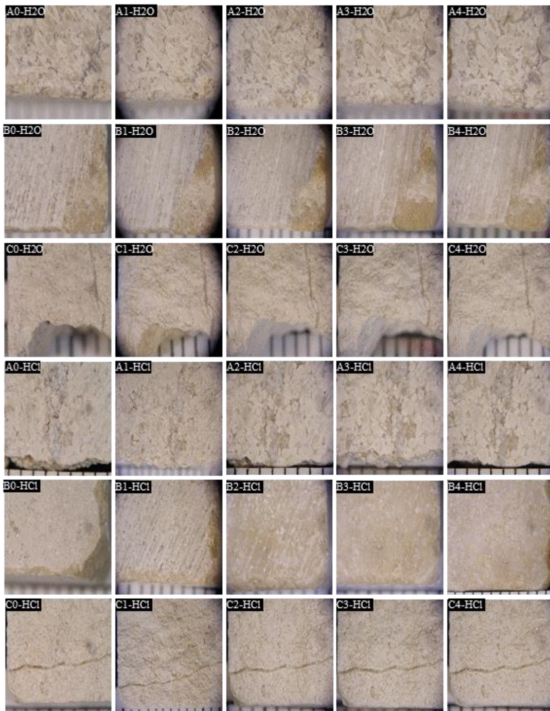
Figura 53 – Imagens do calcário Filstone Blue (A), Crema Paraná (B) e Filstone Beije MF (C) antes do ensaio com extrator de Soxhlet (0) e após os ciclos 1, 2, 3 e 4 aos reagentes H 2 O e HCl.
