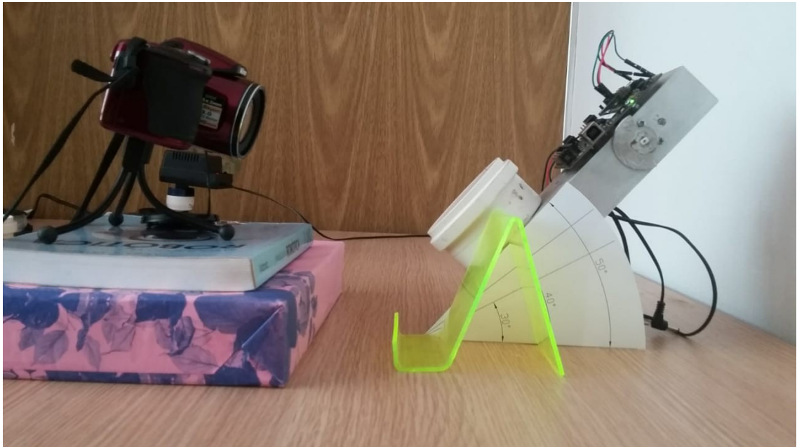
Figura 12: Sistema de filmagem com chassi ajustado para inclinação de 50°.
