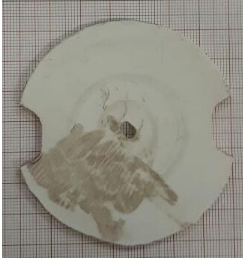
Figura 1: Disco dosador com 2 alvéolos para sementes de milho.
