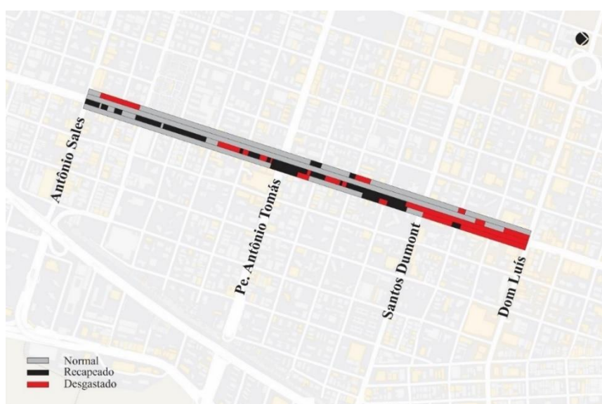
Figura 27 – Avaliação qualitativa da condição superficial do trecho de estudo
