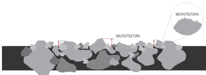
Figura 2 – Níveis de microtextura e de macrotextura (Autor, 2017)
