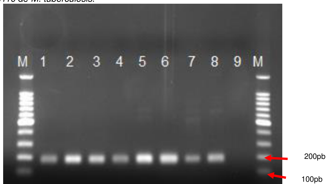
Figura 10 - Eletroforese em gel de agarose 1,5% com produtos de amplificação da região IS6110 de M. tuberculosis .
