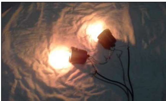
Figura 8: Associação em série de lâmpadas incandescentes comuns em uma tensão de 220 volts
