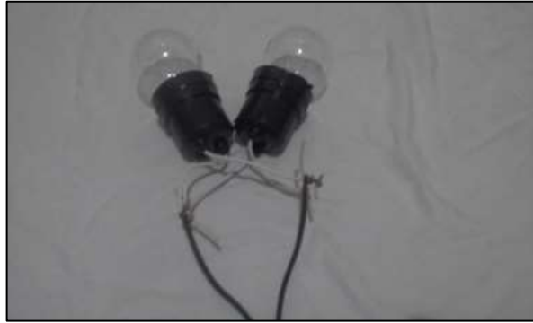
Figura 9: Associação em paralelo de lâmpadas incandescentes comuns para serem ligadas em uma tensão de 220 volts
