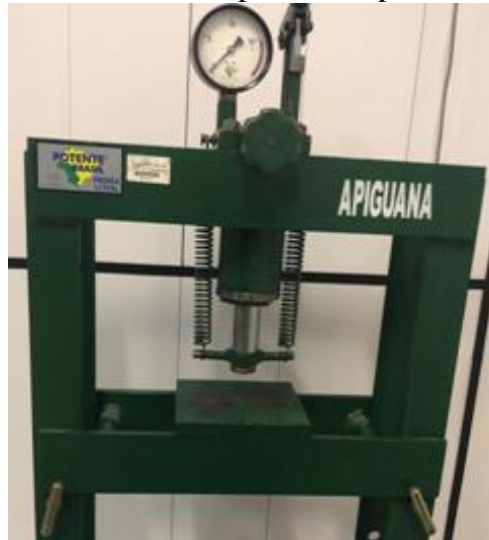
Figura 6 - Prensa hidráulica utilizada para a compressão mecânica da mistura.
