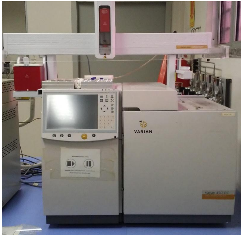
Figura 11 – Cromatógrafo gasoso com sistema de amostragem headspace .
