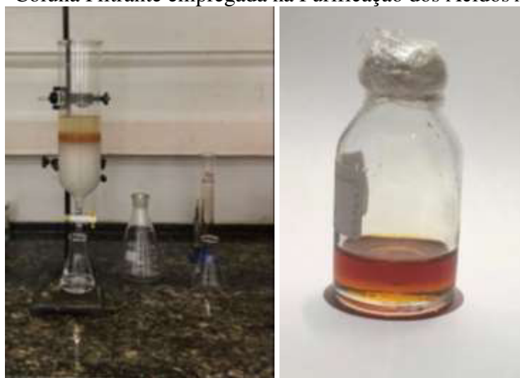
Figura 14 – Coluna Filtrante empregada na Purificação dos Ácidos Anacárdicos
