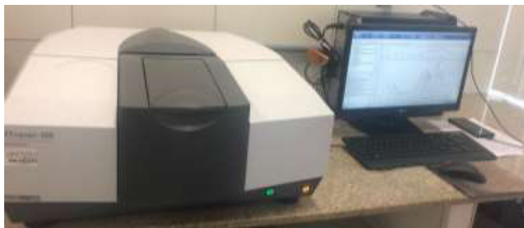
Figura 15 – Espectrômetro de Infravermelho com Transformada de Fourier IRTrace-100
