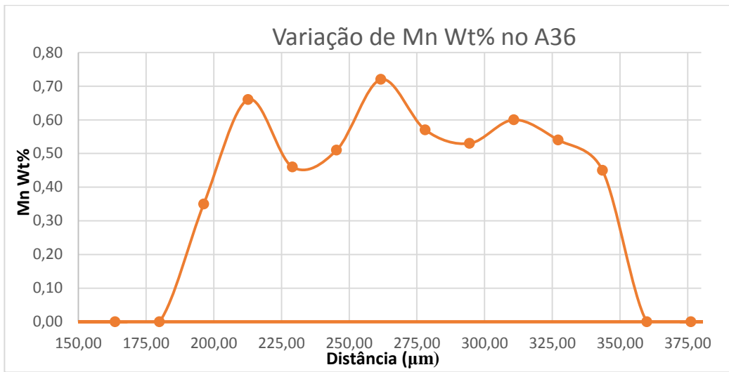
Gráfico 1 - Análise quantitativa por linescan dos elementos presentes no aço A36 após procedimento forjamento e tratamento térmico de difusão.
