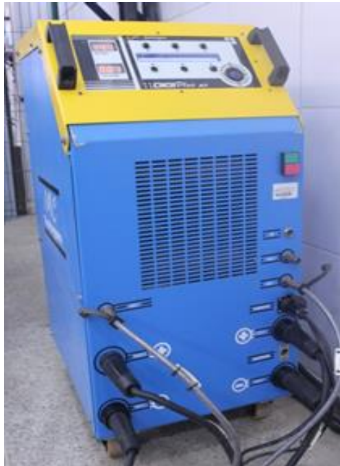
Figura 7: Fonte de Soldagem multiprocesso IMC
