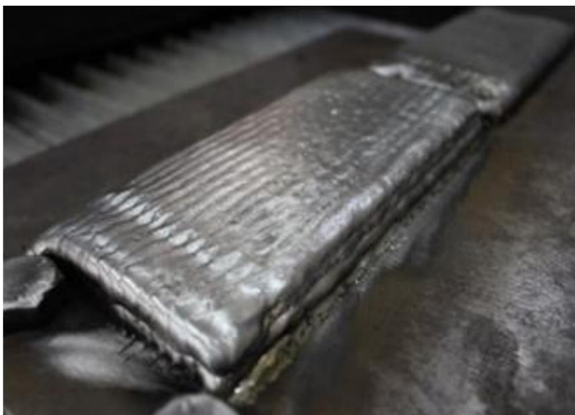
Figura 14: Revestimento B, 63% Hasteloy C276 e 37% Inconel 625
