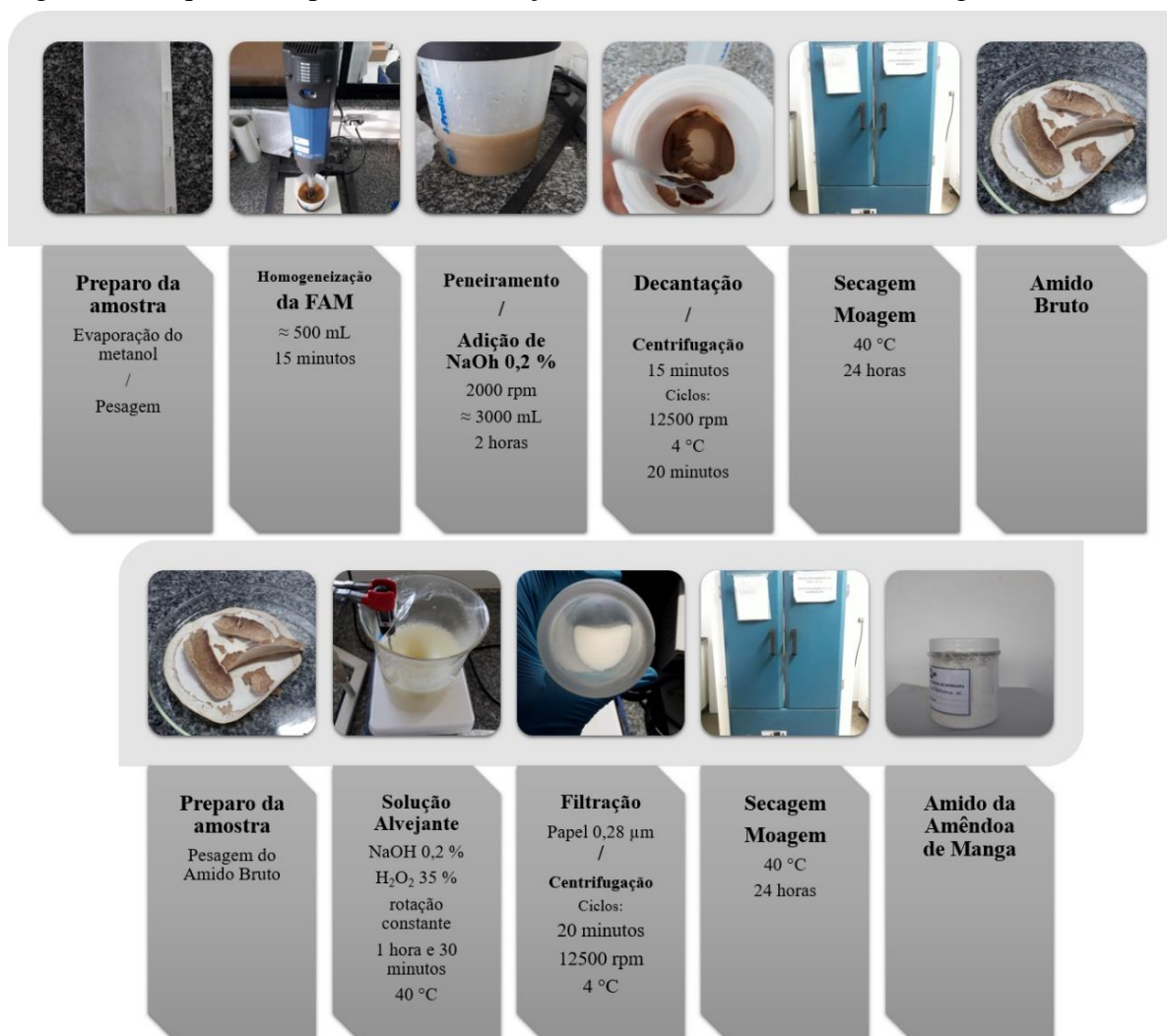
Figura 9 – Esquema do processo de extração de amido de amêndoa de manga.
