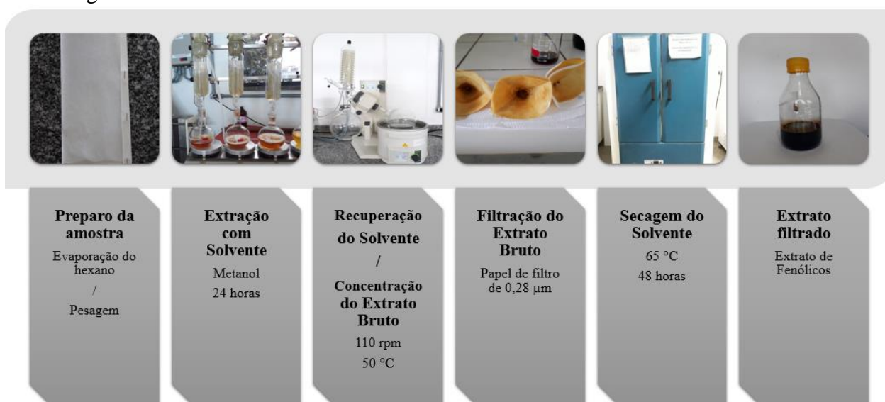
Figura 8 – Esquema do processo de extração do extrato de fenólicos de amêndoa de manga.
