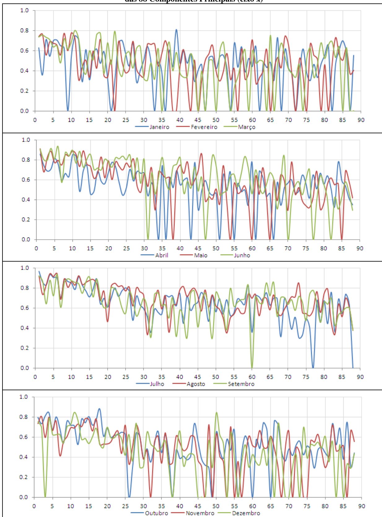
Figura G.2 – Dados de correlações (eixo y) entre os valores dos escores observados e estimados na calibração (1951-1997) do Modelo 6 – ACP/PARX para os 12 meses de cada um das 88 Componentes Principais (eixo x)
