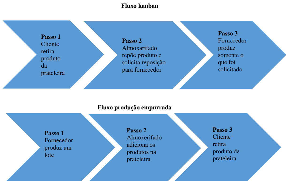
Figura 2 – Fluxo kanban e fluxo da produção empurrada
