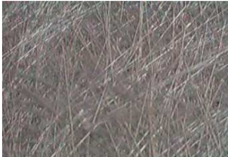
Figura 2.10 - Manta de fios picados – chopped strand mats . Fonte: [33].
