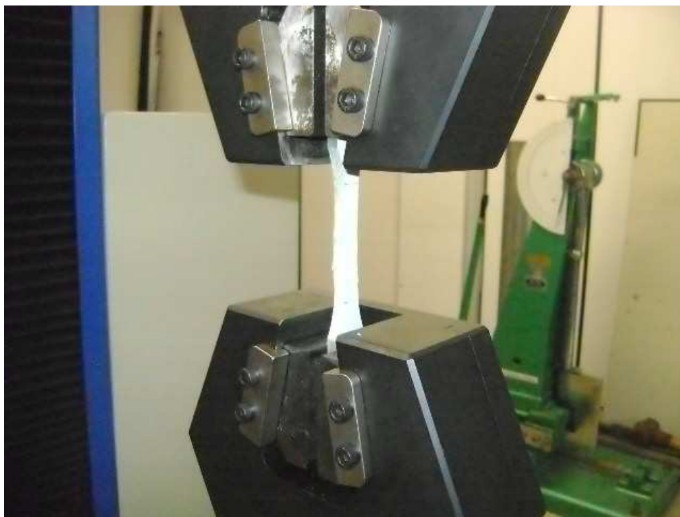
Figura 3.13 – Corpo-de-prova durante o ensaio de tração uniaxial.
