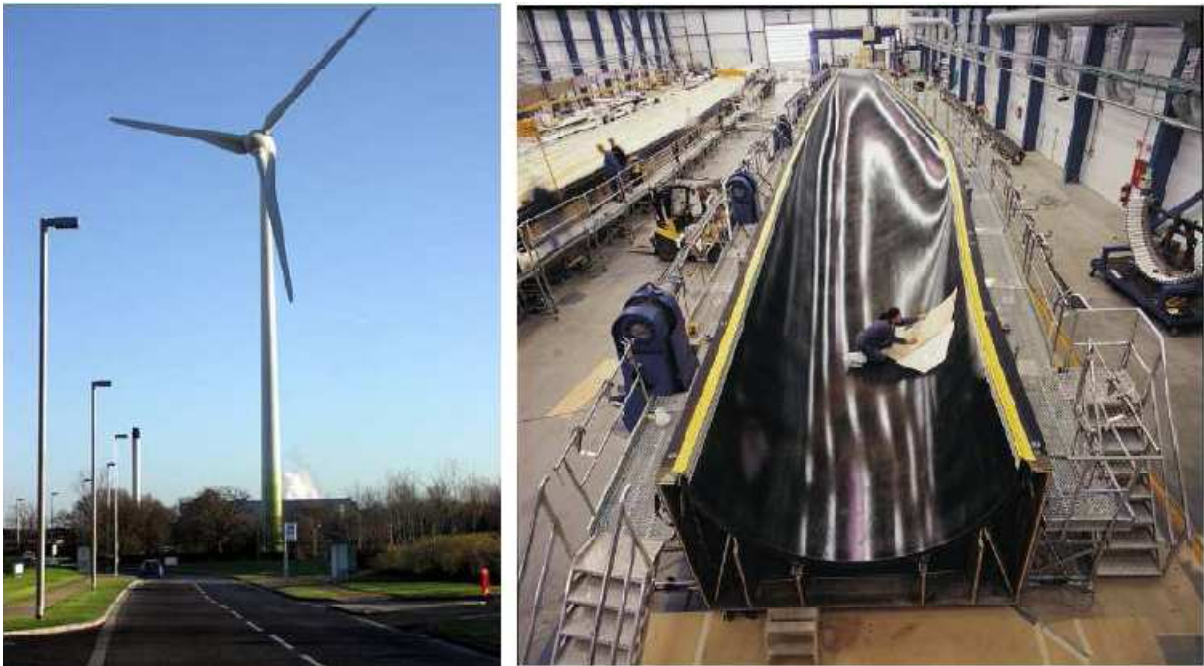
Figura 2.14 – (a) Aerogerador instalado em cidade alemã com hélices de fibra de vidro. (b) Manufatura de uma pá de hélice na LM Glassfiber. Fonte: [3]
