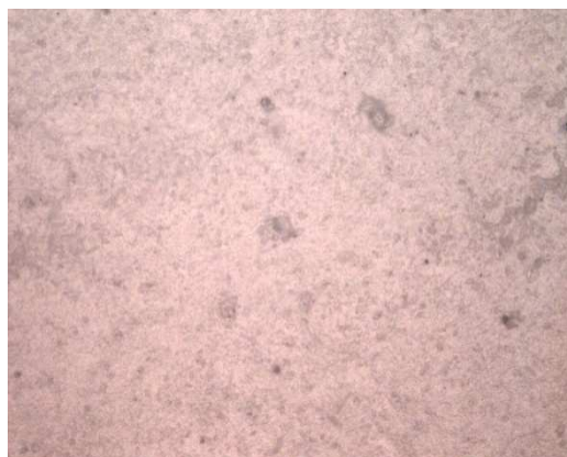
Figura 4.17 – Revestimento de poliuretano nas condições avaliadas: (a) como recebida , (b) 45, (c) 90, (d) 135 e (e) 180 dias degradados aceleradamente. Ampliação de 100x.
