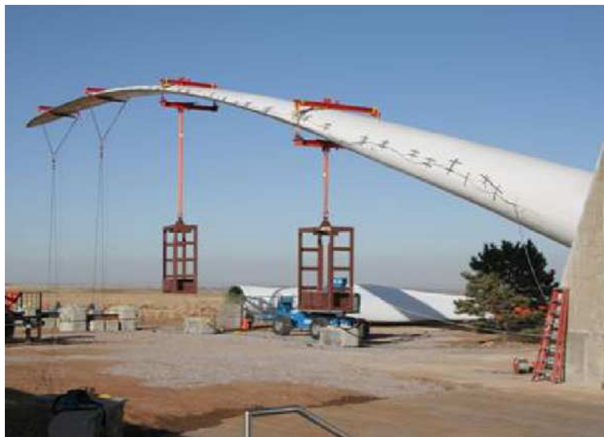
Figura 2.15 – Teste estático aplicado em uma pá eólica. Fonte: [41]
