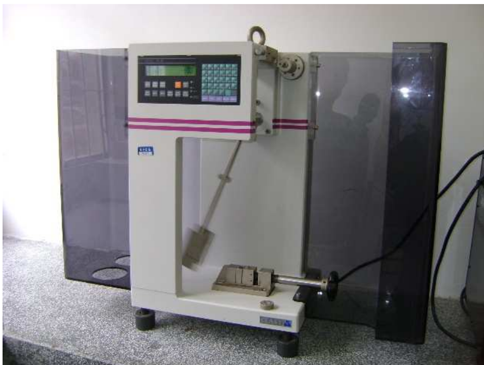
Figura 3.14 – Equipamento utilizado para a realização do ensaio de impacto Izod.
