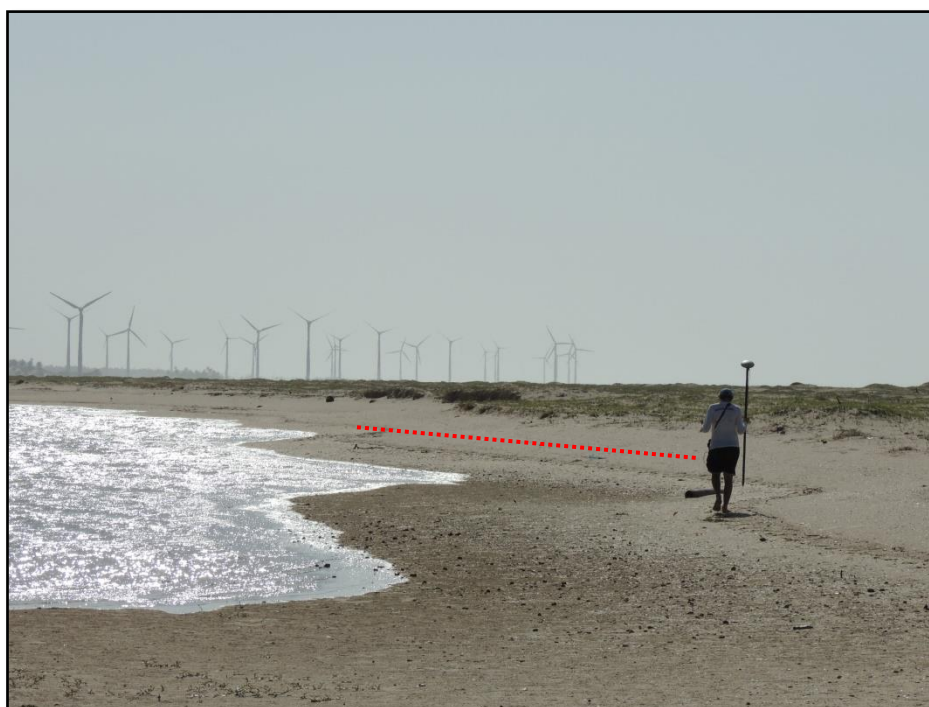
Figura 25 – Monitoramento da linha de costa através do uso de DGPS
