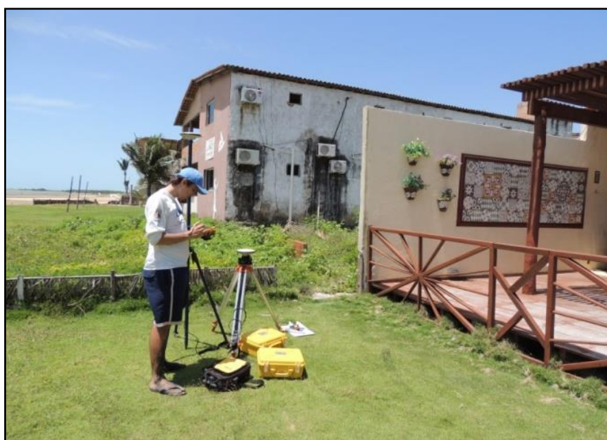
Figura 24 - Transferência de referencial de nível (RN) para a área de estudo
