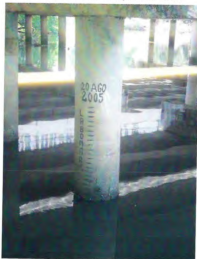
FIGURA 5: Régua limnimétrica, em um dos pilares da ponte.
