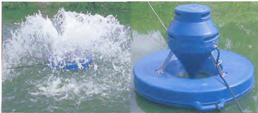
Figuras 3 - Aerador de sucção de ¼ de HP que foi utilizado no viveiro experimental 2 (VE-2), para o cultivo de tilapia do Nilo com água de esgoto doméstico tratado em lagoas de estabilização da ETE da Cagece em Aquiraz – Ceará.
