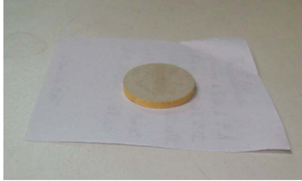
Figura 4.6 - Amostra recoberta com tinta prata para medida com variação de temperatura.
