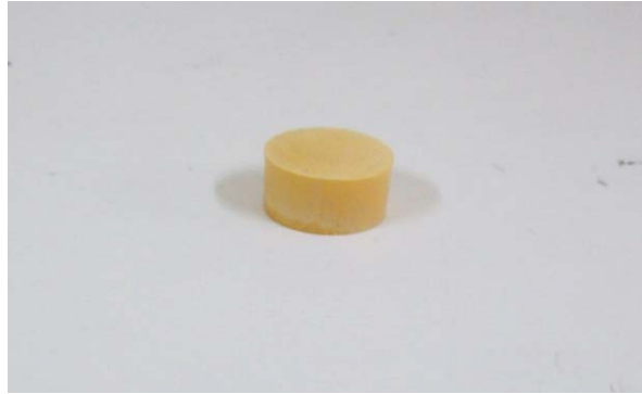
Figura 4.7 - Amostra para medida de micro-ondas, \tau_f , como antena ressoadora dielétrica e picnometria.
