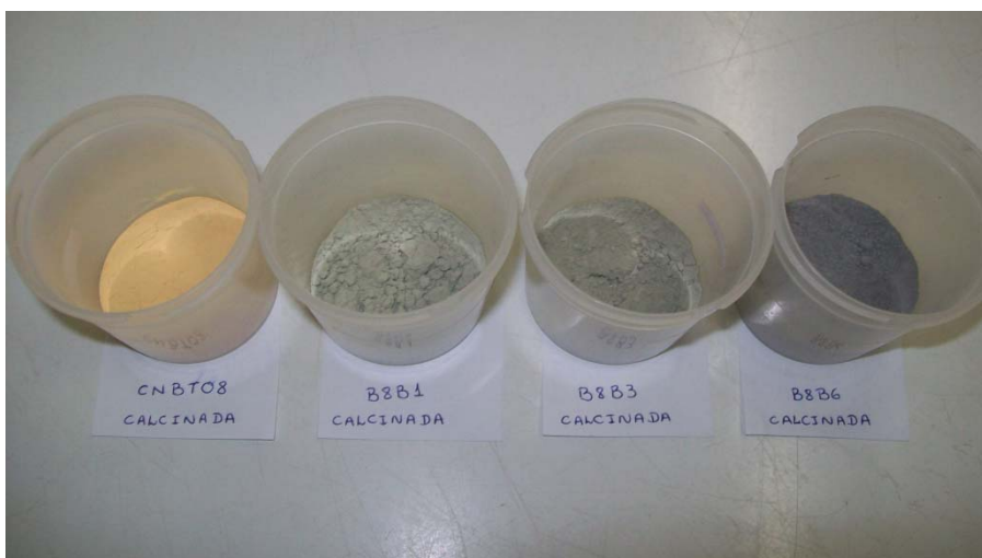
Figura 4.2 - Foto das amostras calcinadas de B8 pura e com adições de B_2O_3 .
