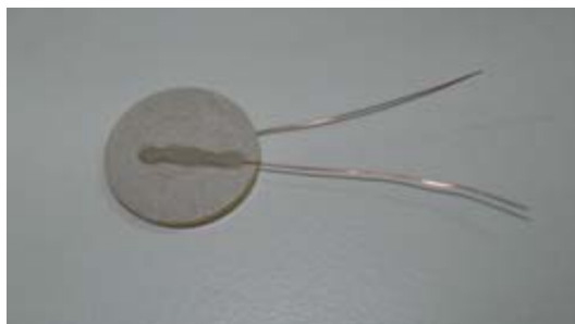
Figura 4.5 - Amostra recoberta com tinta prata e com os eletrodos para medida de 40Hz a 110MHz.
