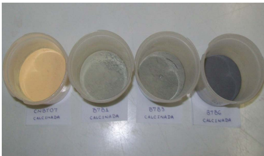
Figura 4.1 - Foto das amostras calcinadas de B7 pura e com adições de B_2O_3 .
