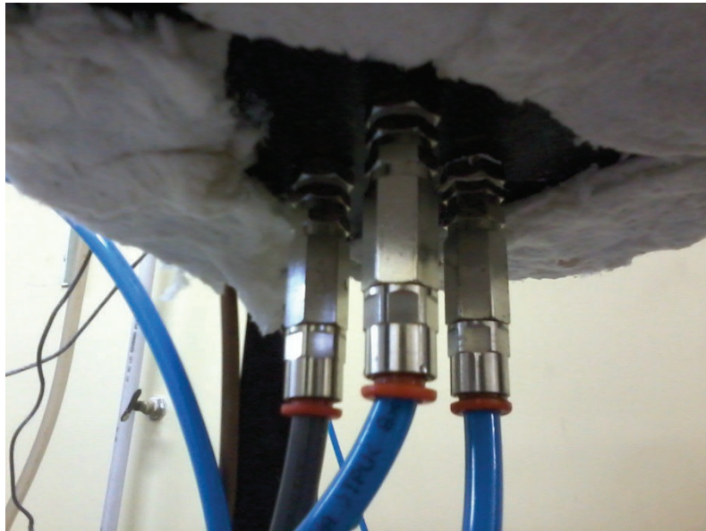
Figura 26: Flange Inferior com válvulas de retenção de entrada de fluidos
