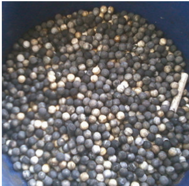
Figura 29: Deposição de Carbono na Superfície das Esferas de Alumina
