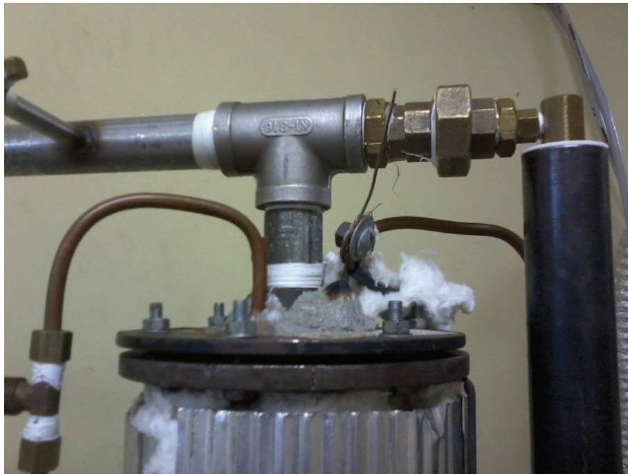
Figura 27: Flange Superior, detalhe da tubulação de exaustão em aço carbono com demais conexões e saída de resistência elétrica de aquecimento do leito
