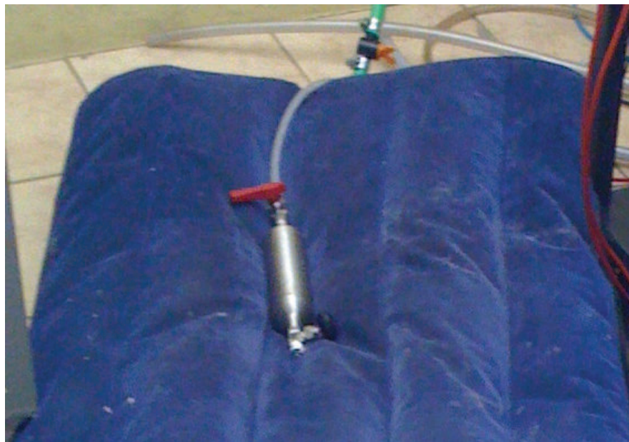
Figura 34: Recipiente de Coleta de Amostra (Cilindro em Aço Inox) e Bolsão para Armazenamento de Amostra
