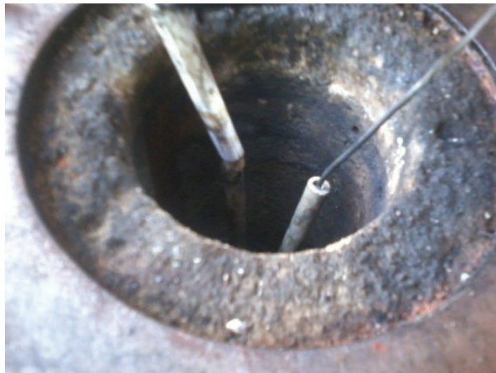
Figura 28: Resistência elétrica sendo montada no reator com tubos cerâmicos isolantes
