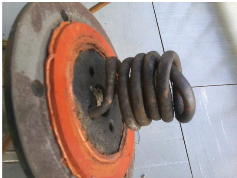
Figura 30: Flange Superior, detalhe do trocador de calor em cobre
