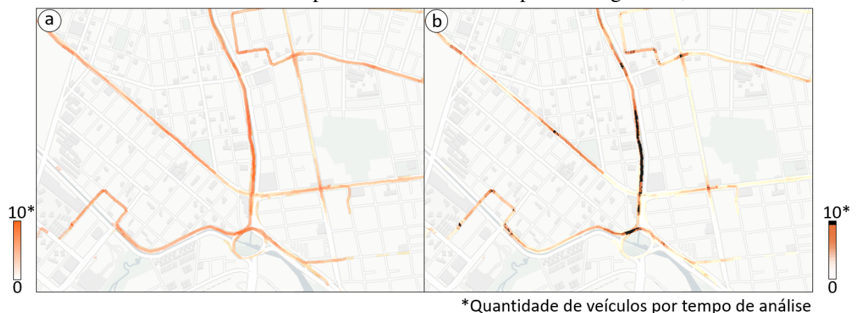
Figura 30 – Exemplo de aplicação da abordagem proposta para encontrar rotas quentes. (a) Trajetórias originais geradas pela etapa de Renderização. (b) Trajetórias suavizadas e com a marcação das rotas quentes realizada na etapa de Processamento Visual destacando com a cor preta toda célula com opacidade igual a 1,0.
