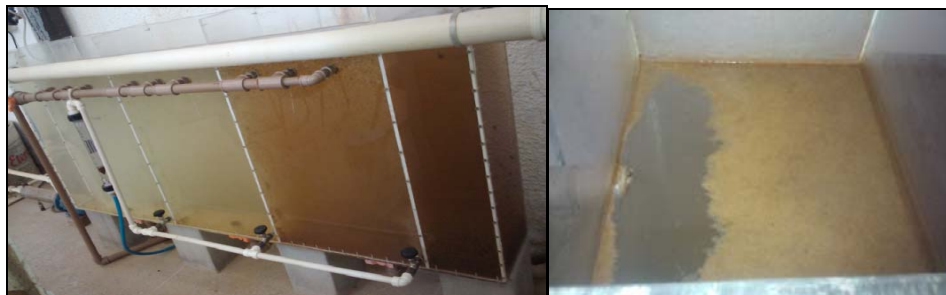
Figura 18 – Vista geral do ensaio de FFAD com taxa de recirculação a 10% (à esquerda) e verificação de arraste de flocos na câmara coletora de água clarificada (à direita).
