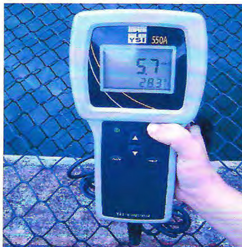
Figura 5 – Oxímetro digital da marca YSI – 550A, utilizado na determinação de oxigênio dissolvido na Estação de Piscicultura Prof. Dr. Raimundo Saraiva da Costa, no Campus Universitário do Pici – Fortaleza – Ceará.
