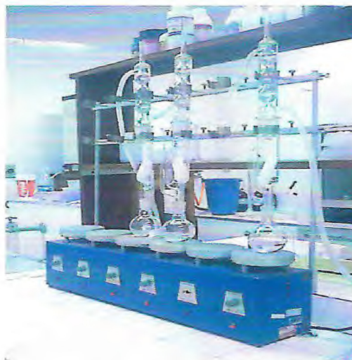
Figura 3 – Extrator de Soxhlet utilizado para determinação de lipídeos no laboratório de Tecnologia de Rações, do departamento de Engenharia de Pesca.
