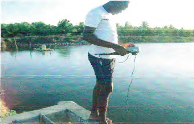
**Figura 12** – Medição do oxigênio dissolvido e temperatura, utilizando-se oxímetro.
