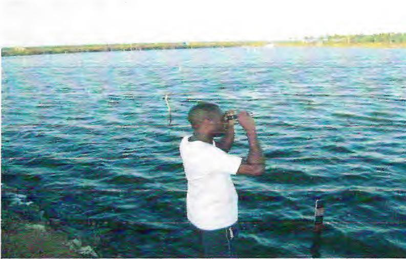
**Figura 14** – Medição da salinidade da água de um dos viveiros com o uso de salinômetro.
