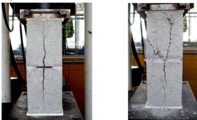
Figura 6 - Dispersão das fissuras em prismas de alvenaria estrutural para o argamassamento parcial (foto da esquerda) e total (foto da direita).
