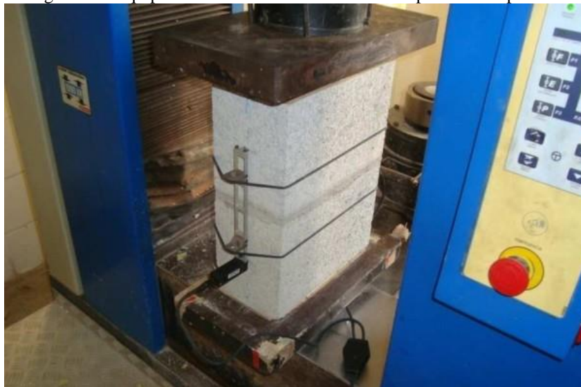
Figura 17 - Equipamento utilizado no ensaio de compressão dos prismas
