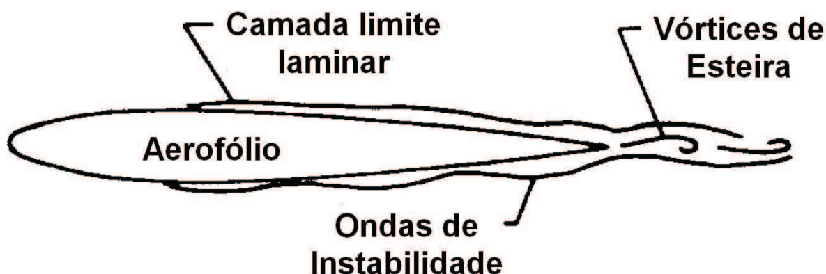
Figura 9 – Ruído de vórtices de esteira da camada limite laminar.
