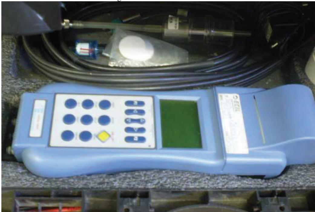
Figura 56 – Analisador de H<sub>2</sub>S.
