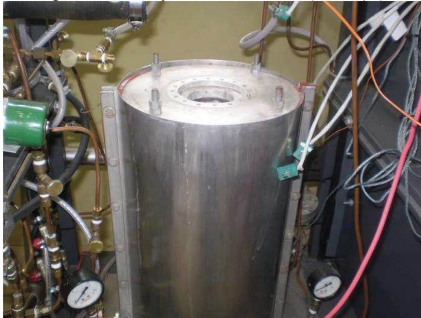
Figura 64 – Vista Superior da Caldeira desmontada para manutenção.
