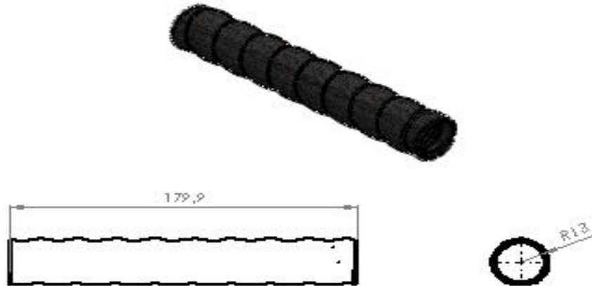
Figura 7 - Suporte para ser fixado no cabo de madeira da recolhedora
