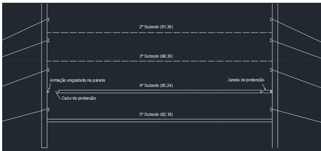
Figura 51 – Esquema das janelas de protensão
