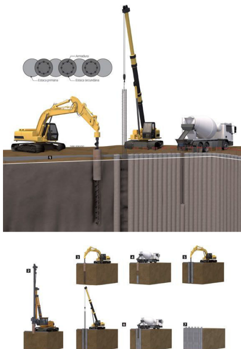
Figura 18 – Execução da estaca secante
