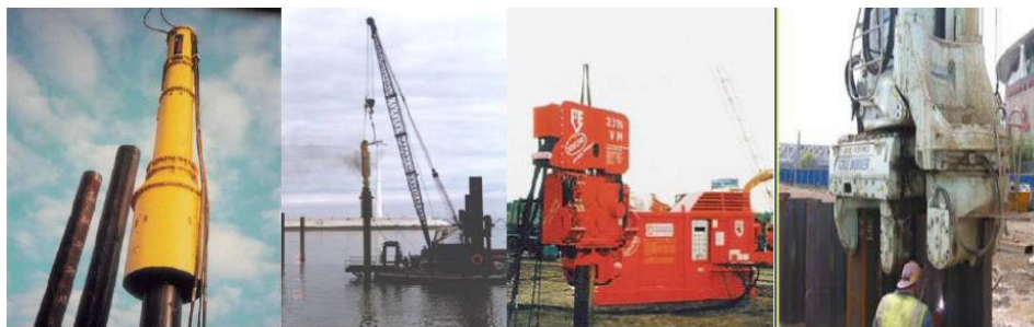
Figura 20 – Martelo Hidráulico, Martelo a Diesel, Martelo Vibratório e Prensa Hidráulica respectivamente
