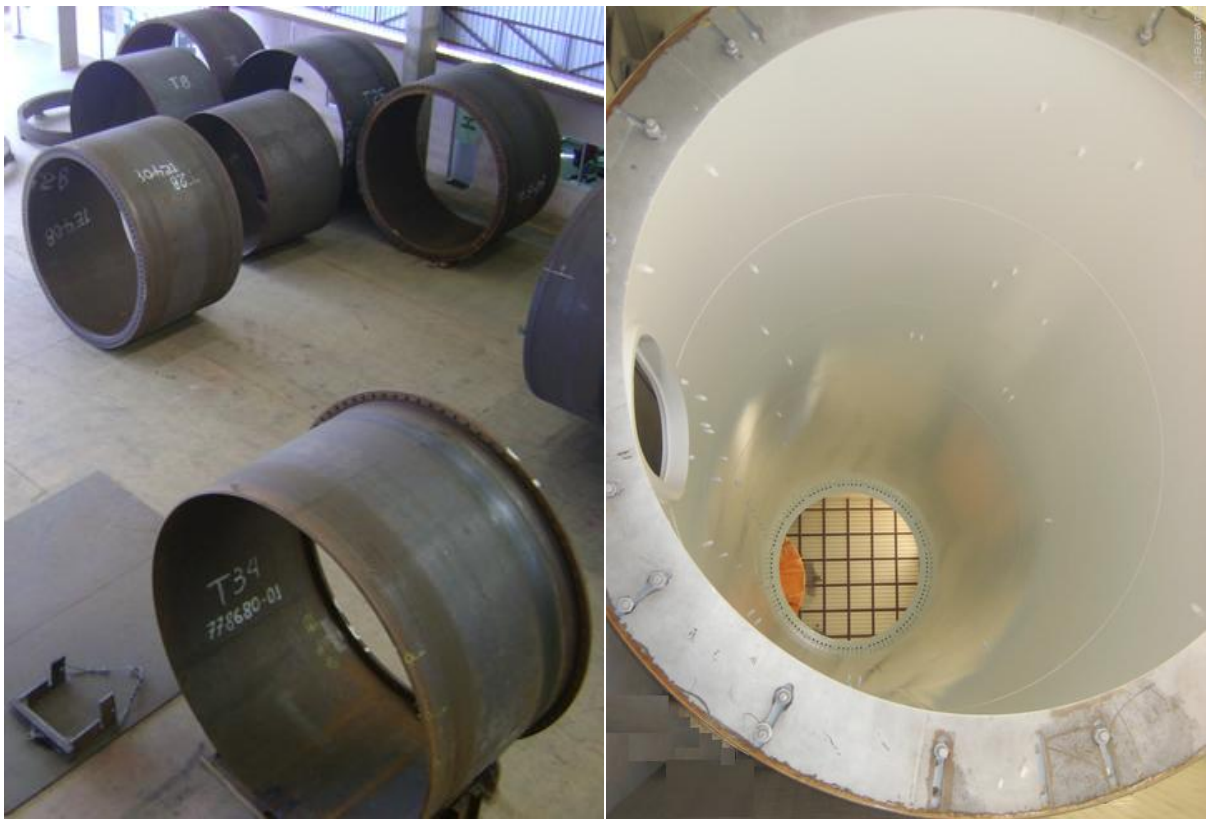
(a) – Visão vários anéis que comporão um segmento-torre.
