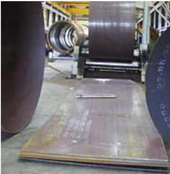
(a) – Chapa de aço antes da conformação.
