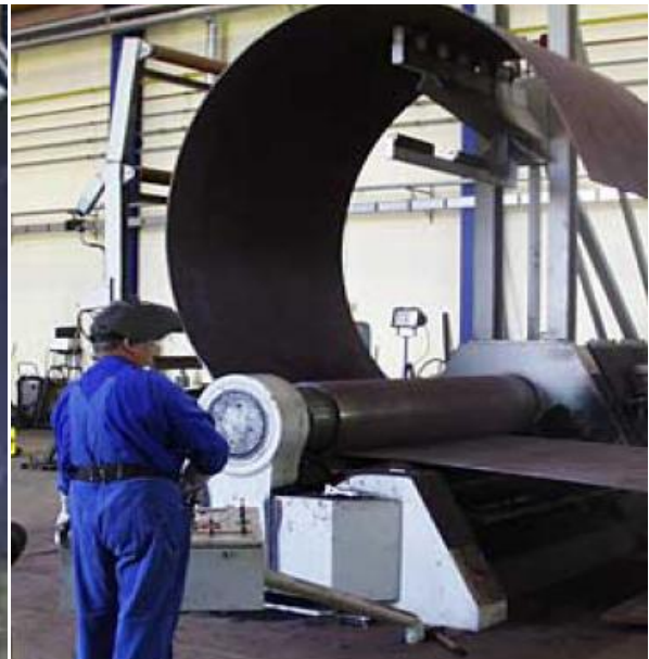
(b) – Calandragem da chapa na forma anel.
