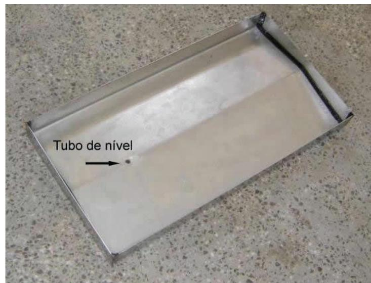
Figura 5.5 – Bandeja de aço inox utilizada nos estágios
