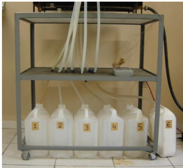
Figura 5.8 – Fotografia da coleta de condensado por estágio
