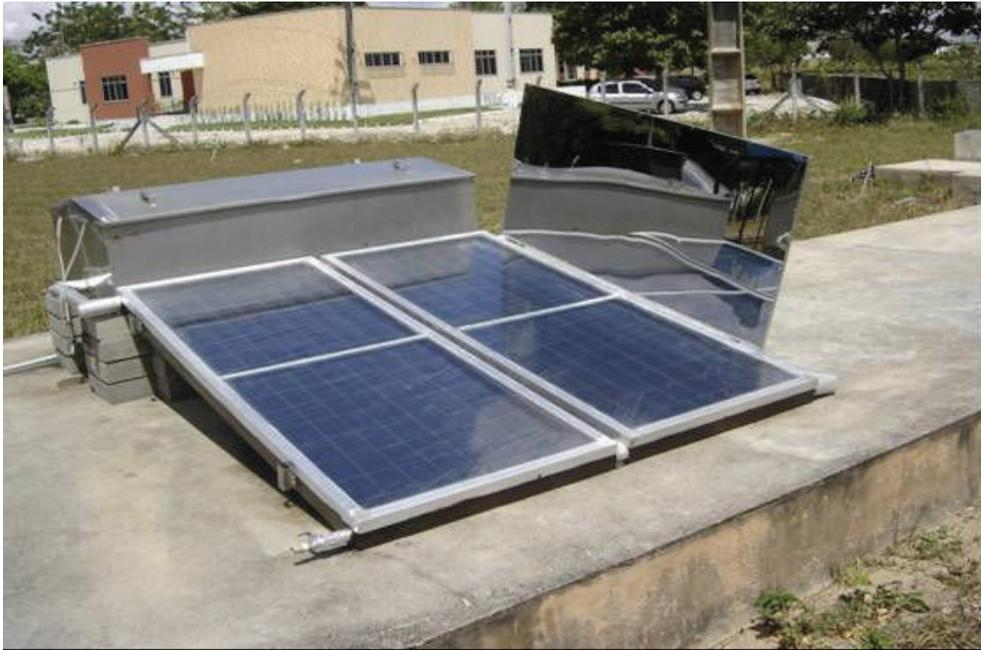
Figura 3.4 – Dessalinizador solar com aquecimento por coletores planos
