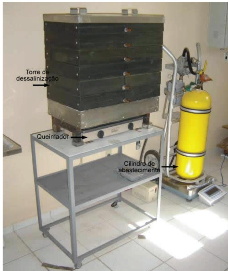
Figura 4.2 – Fotografia do protótipo experimental com seis estágios
