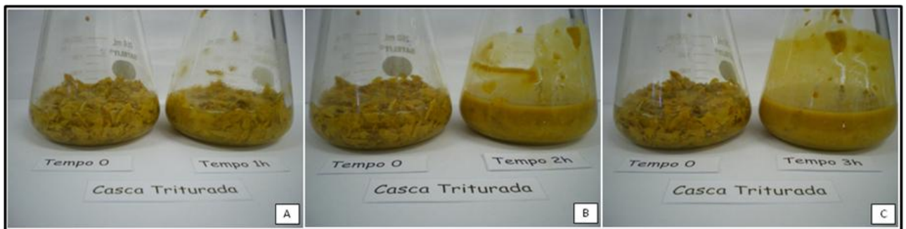
Figura 13 – Tratamento enzimático da película comestível triturada de cajá utilizando 1000 \mu L de Pectinex Ultra SP-L com 50 mL de água destilada nos tempos 0, 1(A), 2(B) e 3h(C).
