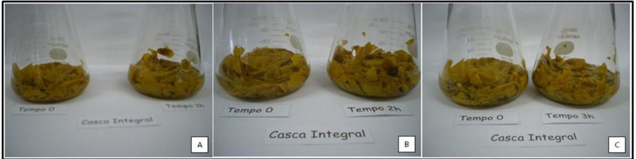
Figura 9 – Tratamento enzimático da película comestível integral de cajá utilizando 1000µL de Biopectinase CCM com 25 mL de água destilada nos tempos 0, 1(A), 2(B) e 3h(C).
