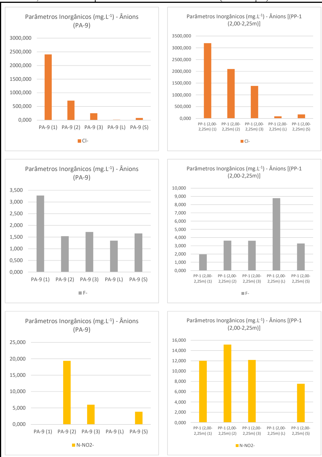
Quadro 16 - Concentração dos parâmetros inorgânicos (ânions e cátions) nos extratos lixiviados, solubilizados e percolados nas amostras analisadas. (Continuação)
