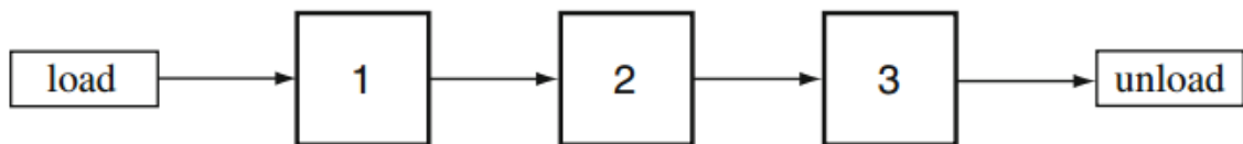
Figura 5 - exemplo de configuração flow shop
